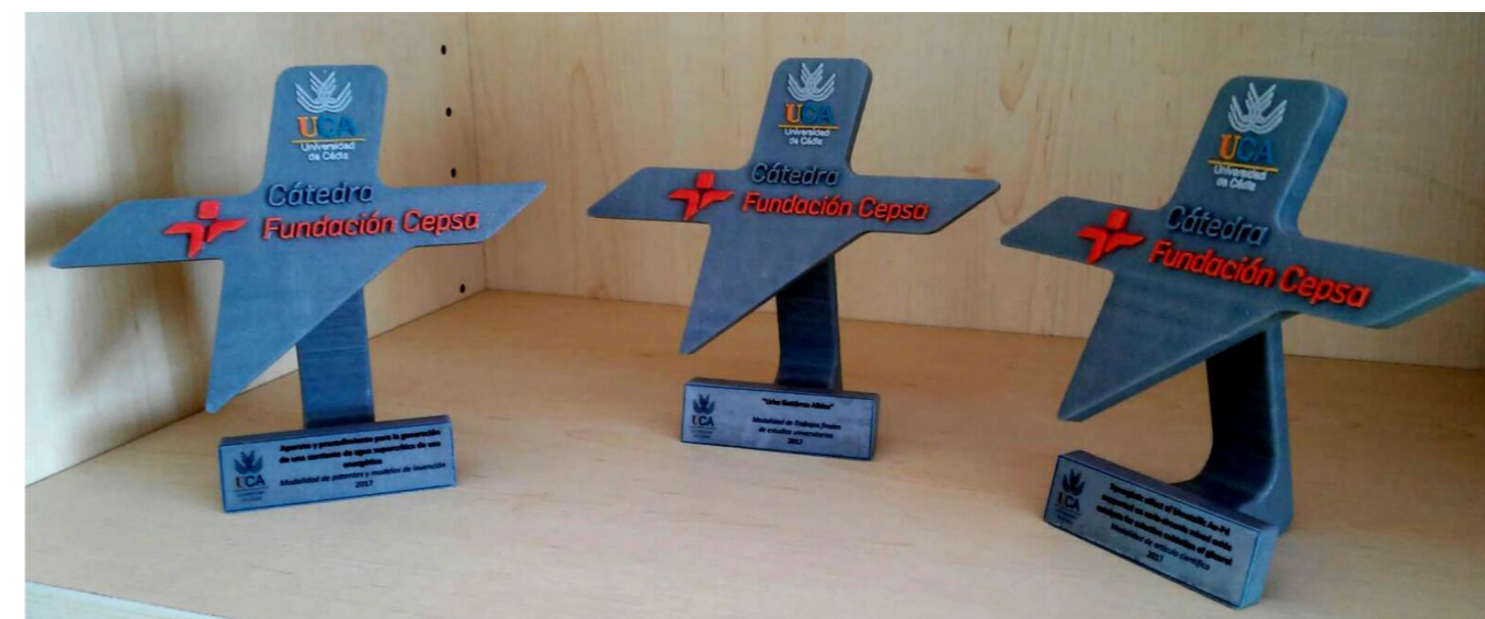
Estatuillas del premio, fabricadas mediante impresión 3D en la división de Fabricación aditiva de la UCA.
